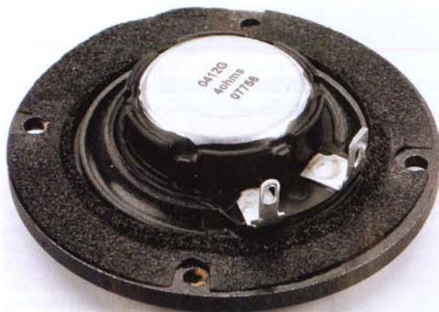
Il tweeter utilizza una cupola da 19 millimetri realizzata in puro titanio. Notale la ghiera di protezione e le dimensioni del complesso magnetico.
