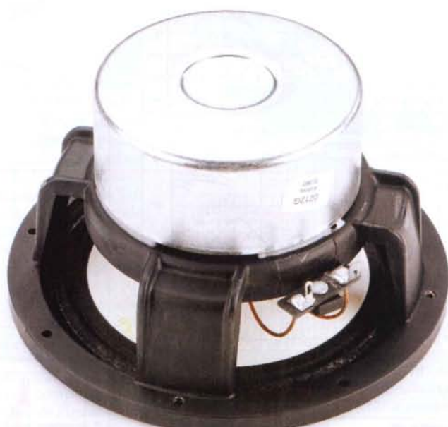
Il woofer utilizzato è dotato di doppio complesso magnetico e di una calotta metallica di copertura. Notare la sospensione a due ondulazioni di derivazione pro ed il cestello in pressofusione.
