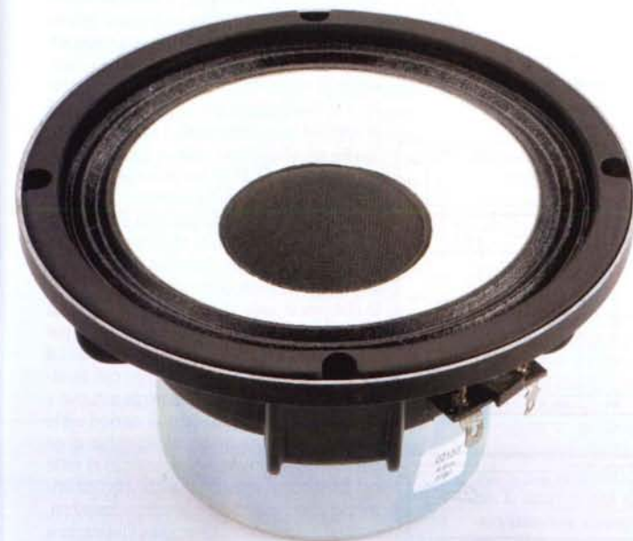
Il woofer utilizzato è dotato di doppio complesso magnetico e di una calotta metallica di copertura. Notare la sospensione a due ondulazioni di derivazione pro ed il cestello in pressofusione.
